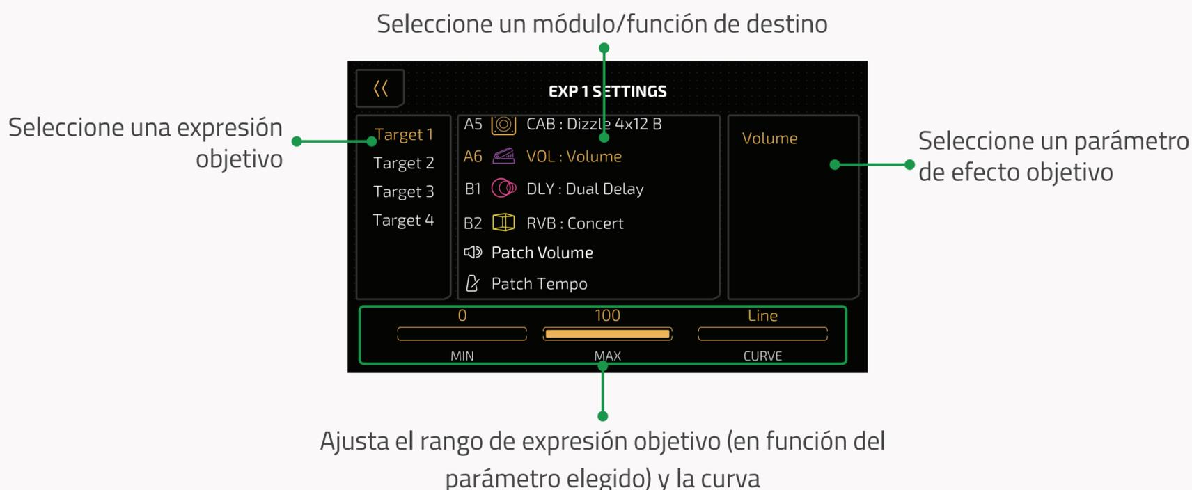
Los objetivos 1-4 le permiten fijar el objetivo de control del pedal. Puede configurar un máximo de cuatro parámetros de efectos/objetivos de función para que los controle el pedal de expresión.
