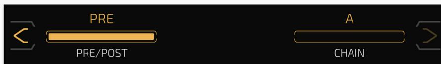
**PRE/POST** selecciona entre colocar el bucle antes (Pre) o después (Post) de sus cadenas de efectos. El tiempo máximo de grabación es de 60 segundos en ambos modos.
