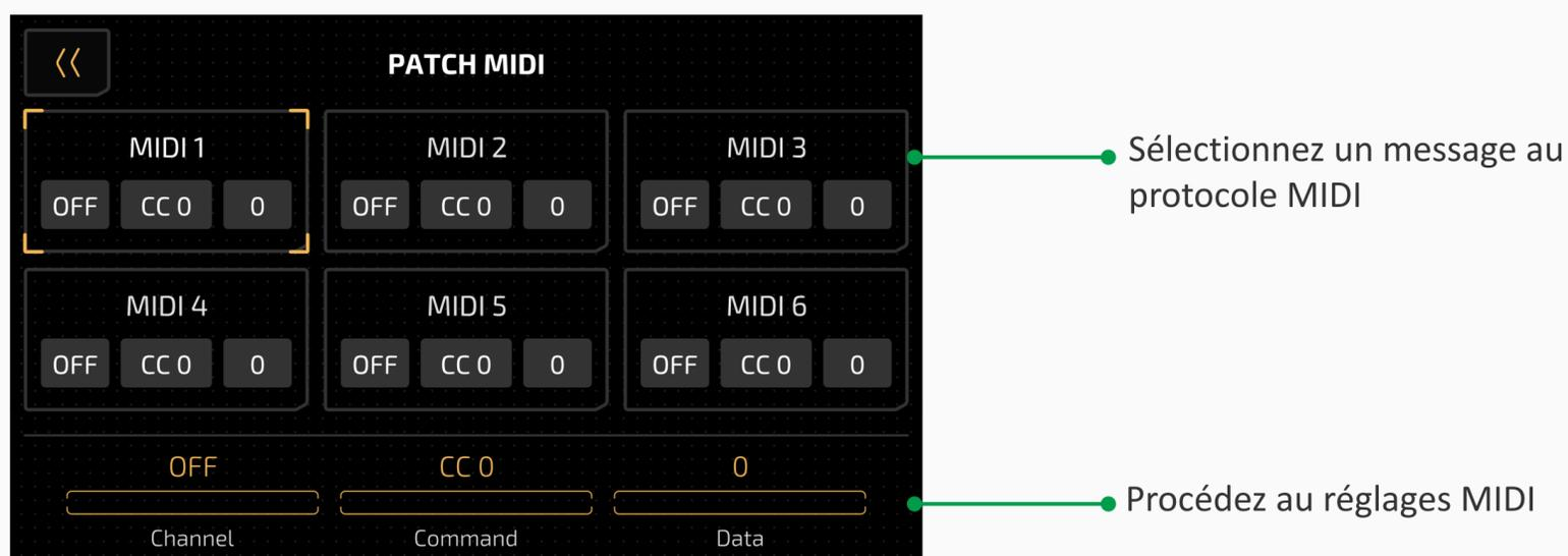
**Channel** pour régler le canal de sortie de protocole MIDI. La plage de réglages est comprise entre OFF~1~16~Omni ; le réglage par défaut est OFF.
