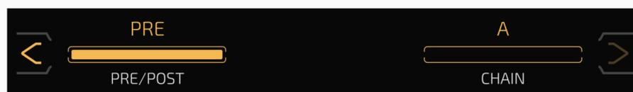
**PRE/POST** permet de choisir entre le réglage de la boucle avant (Pre) ou après (Post) vos chaînes d'effets. La durée d'enregistrement maximale est de 60 secondes dans les deux modes.
