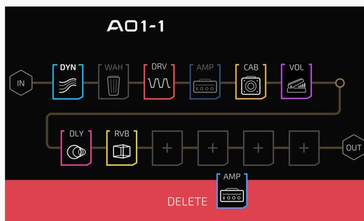
Lors du déplacement / interversion des modules, la zone de suppression rouge apparaît également. Vous pouvez également déposer le module dans la zone pour supprimer le module sélectionné.
