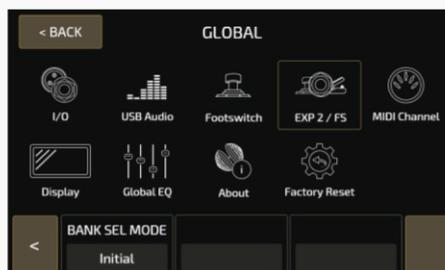
Vous pouvez sélectionner le mode de sélection des mémoires de l'Ampero lorsque vous utilisez l'Ampero Switch à titre de permutateur de mémoires. Le mode « Bank Sel » vous permet de sélectionner entre deux modes : Initial et Wait (changer et patienter).
